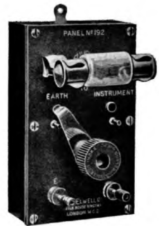
Antenne-aardschakelaar met vonken-brug, welke, ten einde het indringen van stof te verhinderen, in glas is gebouwd.
